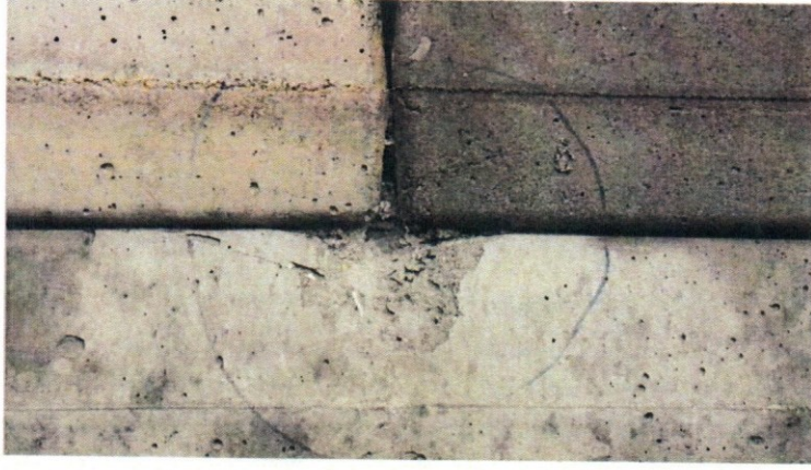
5 metreden atış sonrası duvardaki durum
