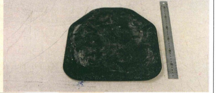
Test Numunesinin Atış Sonrası Arka Yüzey Resmi Back Surface Image of Test Sample After Shooting
