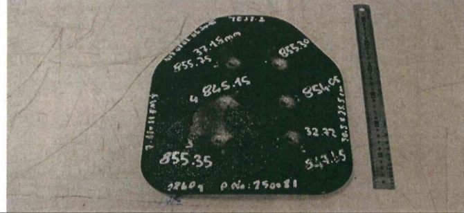
Test Numunesinin Atış Sonrası Ön Yüzey Resmi Front Surface Image of Test Sample After Shooting
