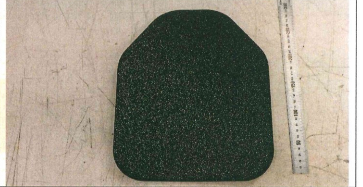
Test Numunesinin Atış Sonrası Arka Yüzey Resmi Back Surface Image of Test Sample After Shooting
