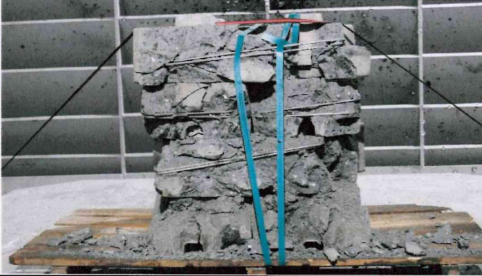
Test Numunesinin Atış Sonrası Ön Yüzey Resmi Front Surface Image of Test Sample After Shooting
