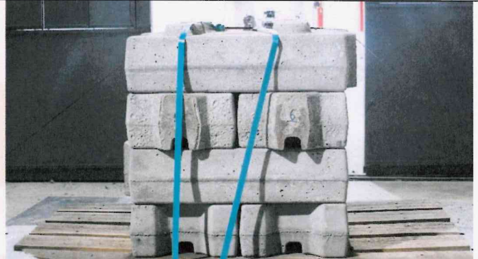
Test Numunesinin Atış Sonrası Arka Yüzey Resmi Rear Surface Image of Test Sample After Shooting
